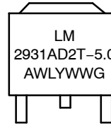
D2PAK D2T SUFFIX CASE 936
