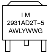
D2PAK D2T SUFFIX CASE 936
