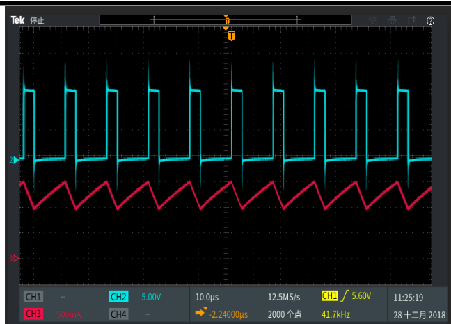
SW 脚与电感电流工作波形
